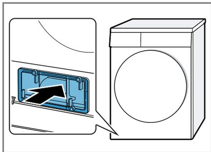
2. Chiudere la leva della copertura dello scambiatore di calore.
