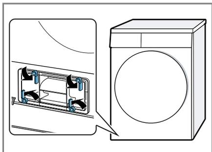
3. Estrarre la copertura dello scambiatore di calore sulla maniglia.
