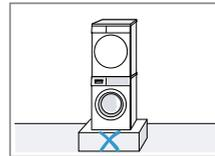
Installare questo apparecchio in una colonna lavatrice-asciugatrice soltanto con il set di collegamento originale del produttore dell'asciugatrice. Collocare questo apparecchio su una lavatrice solo se è dello stesso produttore. La profondità e la larghezza
