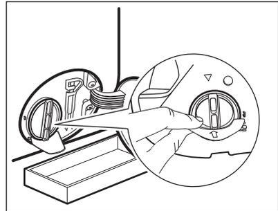
4. Ruotare il filtro di 180 gradi in senso anti-orario per aprirlo, senza rimuoverlo. Lasciare che l'acqua fuoriesca.
