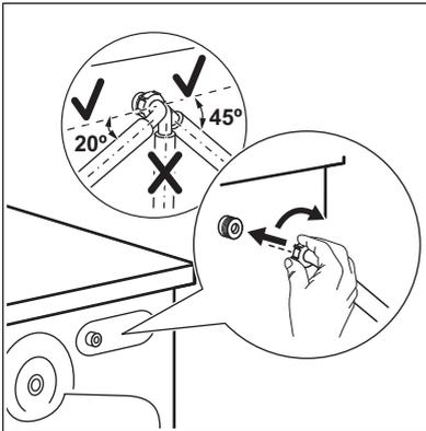
2. Posizionarlo a sinistra o destra, a seconda della posizione del rubinetto. Assicurarsi che il tubo di carico non sia in posizione verticale.
