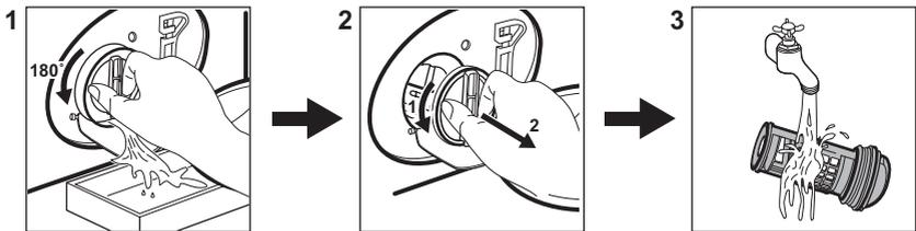
Pulire il filtro a intervalli regolati, e in particolar modo se il codice allarme **E2**
