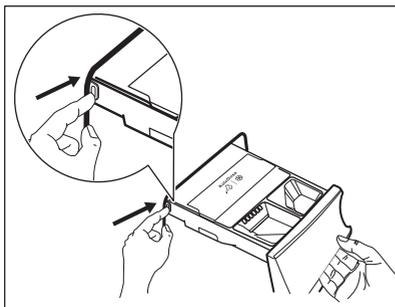
2. Rimuovere l'inserto per l'ammorbidente e, se inserito, il contenitore per il detersivo liquido.
