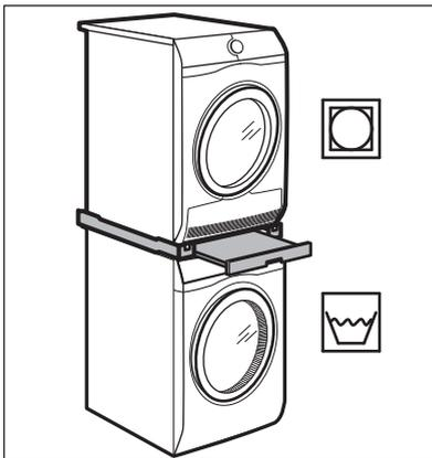
L'asciugatrice può essere installata in colonna al di sopra della lavabiancheria **soltanto utilizzando l'appropriato kit di installazione in colonna prodotto ed approvato da ELECTROLUX.**
