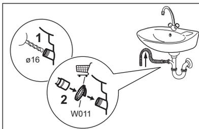
Collegare il tubo di scarico al sifone e serrarlo con una pinza. Accertarsi che il tubo di scarico formi una curva per evitare che particelle passino dal lavandino all'apparecchiatura.
