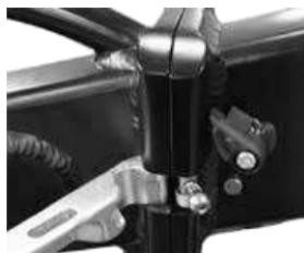
3) Chiudere la leva di fissaggio e inserire il perno di sicurezza nella sua sede.
