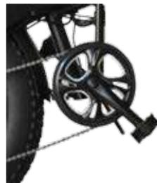
**AVVISO:** Per evitare che si allentino durante il viaggio, i pedali (di tutte le biciclette) hanno la caratteristica di avere il pedale sinistro con filettatura inversa. In pratica, quando li avviti, è necessario farlo nella direzione opposta, come se si stesse svitando.
