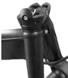
La VF21 arriva con il piantone di sterzo abbassato
