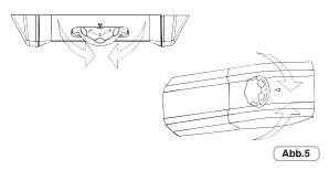
Die Temperaturregelung beider Abschnitte erfolgt durch Drehen des Thermostatreglers (Abb. 5).
