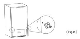
3 Régler les pieds pour garantir la stabilité de l'appareil et éviter les vibrations et les bruits (fig.3). Si la partie avant est plus haute que l'arrière, la porte se ferme plus facilement.
