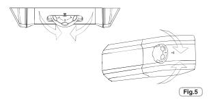
O ajuste da temperatura de ambos os compartimentos (frigorífico e congelador) é feita por rotação do botão do termóstato (fig. 5). Seleccione a posição desejada:
