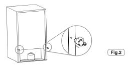
3 Ajuste os pés para garantir a estabilidade do aparelho e reduzir as vibrações e ruídos (fig. 3). Se a parte frontal for maior do que a parte traseira, a porta pode ser fechada com mais facilidade.
