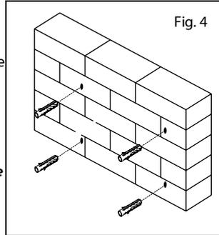
**NOTA:** se il muro di cemento è coperto da uno strato di intonaco o muro a secco, l'ancoraggio per calcestruzzo deve passare completamente attraverso lo strato per rimanere a filo con la superficie del calcestruzzo.
