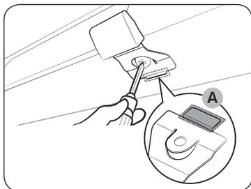
1. Inserire la parte sottile **(A)** del blocco meccanico nel corrispondente alloggiamento del braccio del blocco come mostrato in figura.
