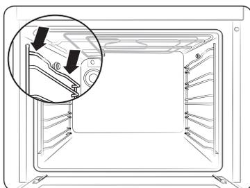
1. Premere la parte centrale della parte superiore della guida laterale.
