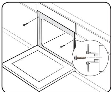
Inserire il forno nella struttura a incasso e fissarlo saldamente su entrambi i lati con 2 viti.
