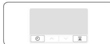
Premere simultaneamente per 3 secondi i tasti e per attivare il blocco, oppure premere nuovamente per 3 secondi per disattivare il blocco sul pannello di controllo.
