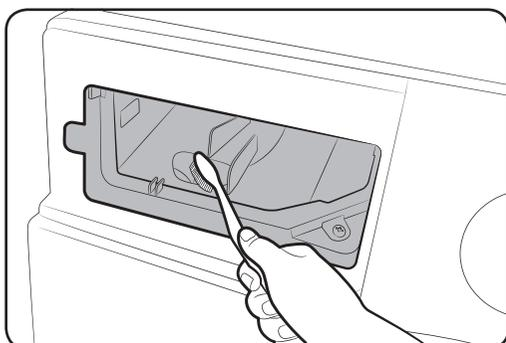
3. Pulire il vano del contenitore con una spazzola per bottiglie per rimuovere i residui di detersivo e il calcare dal vano del contenitore.
