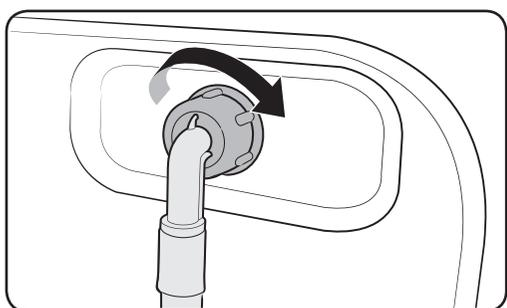
2. Collegare l'altro terminale del tubo di carico dell'acqua alla valvola di carico posta sul retro della lavatrice. Ruotare il tubo in senso orario per serrarlo.
