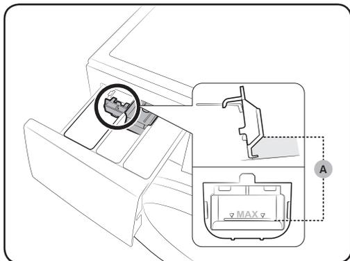
Inserire per primo il contenitore per liquidi in dotazione nel **II** comparto lavaggio principale. Quindi, versare il detersivo liquido nel contenitore sotto la linea max (A).
