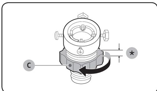
3. Tenendo l'adattatore, ruotare la parte (C) in direzione della freccia per allentarlo di 5 mm (\*).
