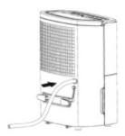
Note: il tubo dell'acqua non deve essere troppo lungo (solitamente 0.6m), l'altezza non deve superare l'altezza della bocca di drenaggio onde evitare fuoriuscite d'acqua.
