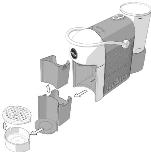
**2** Remova e esvazie a gaveta coletora de cápsulas utilizadas. Lavar e secar todas as partes antes de montá-las novamente.
