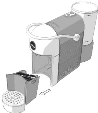
**1** Die Tropfenauffangschale ausziehen und den Tassen-aufstellrost entfernen.
