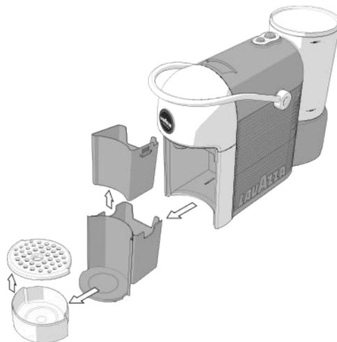
**2** Retirar y vaciar el cajón de recogida de cápsulas usadas. Lavar y secar todas las partes antes de montarlas nuevamente.
