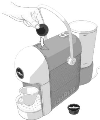
**3** Bajar la palanca de carga de cápsulas para cerrar el compartimiento de introducción de cápsulas.
