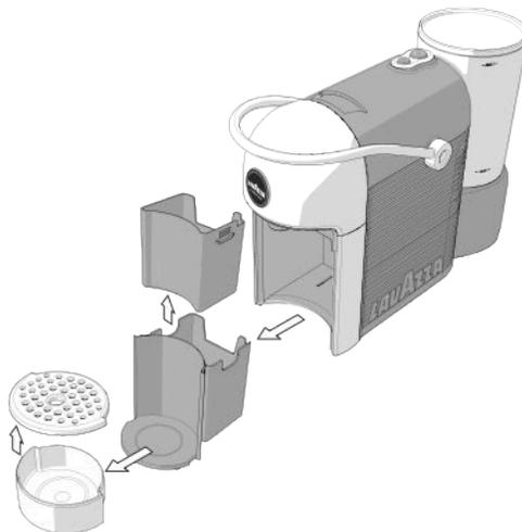
**2** Den Behälter für verbrauchte Kapseln entfernen und entleeren. Vor Wiedereinbau alle Bestandteile abspülen und abtrocknen.
