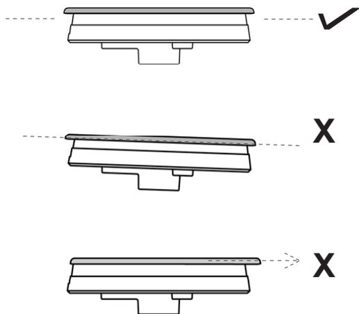
Il posizionamento errato di spartifiamma e cappellotto può portare al danneggiamento del bruciatore.
