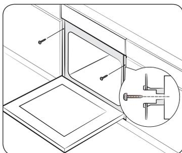
Inserire il forno nella struttura a incasso e fissarlo saldamente su entrambi i lati con 2 viti.
