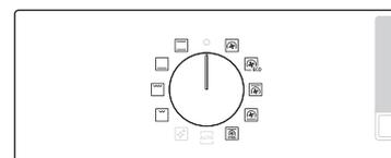
1. Ruotare il selettore della modalità per selezionare una modalità o una funzione. Viene visualizzata la temperatura preimpostata per ogni selezione.
