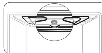
1. È possibile smontare l'elemento riscaldante della griglia in modo da facilitare la pulizia del cielo del forno. Rimuovere il dado superiore circolare ruotandolo in senso antiorario e sostenendo al contempo l'elemento riscaldante.
