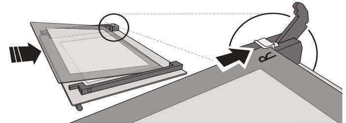
**4.** Rimontare il profilo superiore: un clic indica il corretto posizionamento. Verificare che la tenuta sia salda prima di rimontare la porta.
