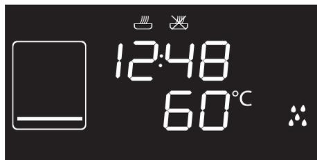
2. Ruotare la manopola temperatura a destra o a sinistra per posticipare l'orario di fine cottura.
