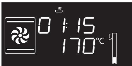
3. Premere la manopola temperatura una quarta volta. La spia
