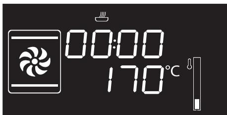
2. Ruotare la manopola a destra o a sinistra per impostare la durata di cottura da 00:01 a 12:59. Mantenere ruotata la manopola per avere un incremento o una diminuzione veloce.
