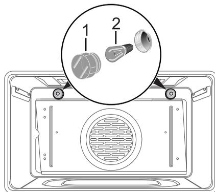
3. Rimontare la copertura di protezione **1**.
