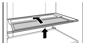
**Rimozione/Rimontaggio del ripiano pieghevole**
