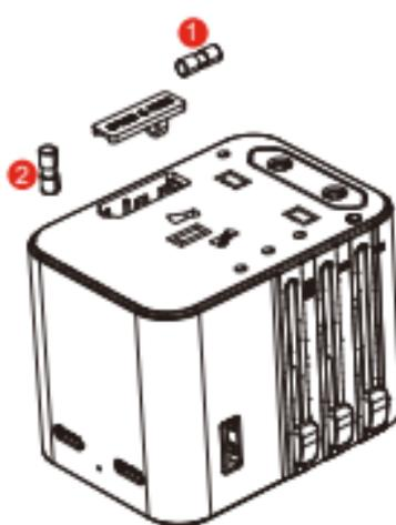
Fusibile da sovraccarico 10A, il fusibile si interromperà automaticamente in caso di sovraccarico, sostituirlo con un fusibile di ricambio da 10A.
