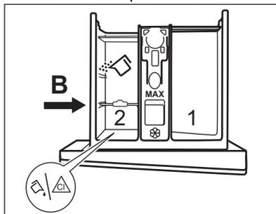
La posizione **B** del divisore del detersivo è per il detersivo in polvere nello scomparto posteriore e per il detersivo liquido/additivo o candeggina nello scomparto anteriore.
