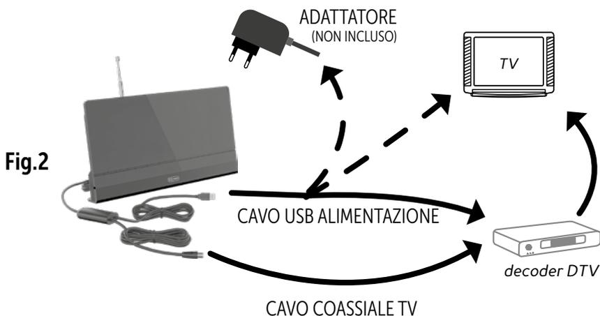
**NOTA:** Al termine dell'installazione, è possibile utilizzare il decoder DTV per verificare la potenza e la qualità del segnale. Se non si vede un'immagine stabile, spostare l'antenna in una posizione di ricezione migliore. Una volta trovata la posizione migliore, mantenerla.
