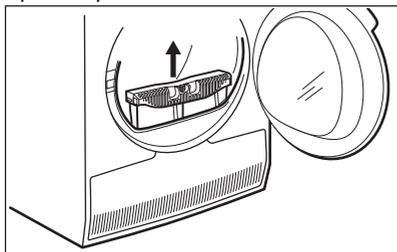
2. Aprire la copertura del condensatore.
