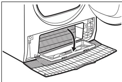
5. Se necessario, togliere la lanugine dal condensatore e dal suo alloggiamento. È possibile utilizzare un aspirapolvere con un accessorio a spazzola.
