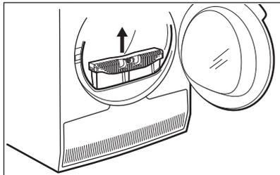
2. Aprire la copertura del condensatore.
