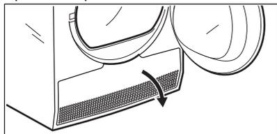
3. Ruotare le leve per sbloccare il coperchio del condensatore e abbassare il coperchio del condensatore. .
