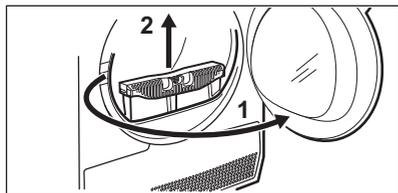
2. Aprire la copertura del condensatore.
