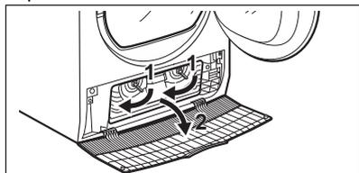
4. Se necessario, togliere la lanugine dal condensatore e dal suo alloggiamento. È possibile utilizzare un aspirapolvere con un accessorio a spazzola.
