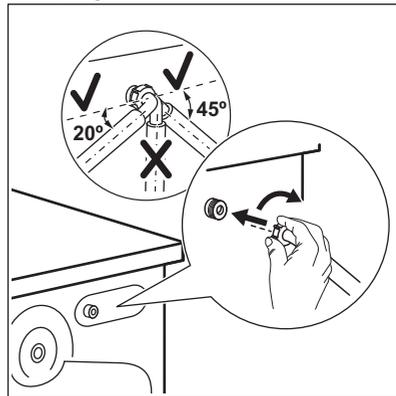
2. Posizionarlo a sinistra o destra, a seconda della posizione del rubinetto. Assicurati che il tubo di carico non sia in posizione verticale.
