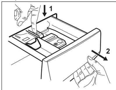
2. Togliere la parte superiore dello scomparto additivi per semplificare la procedura di pulizia. Verificare che tutti i residui di detersivo vengano rimossi dalla parte superiore e inferiore dell'incasso. Servirsi di una spazzola piccola per pulire l'incasso.
