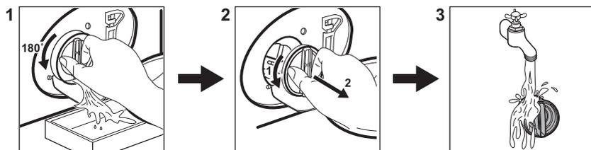
Pulire il filtro a intervalli regolati, e in particolare modo se il codice allarme **E20** viene visualizzato sul display.
