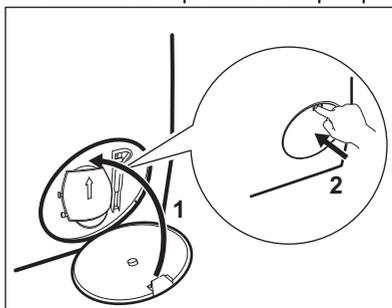
Quando si scarica l'acqua utilizzando la procedura di scarico di emergenza, è necessario attivare di nuovo il sistema di scarico:
