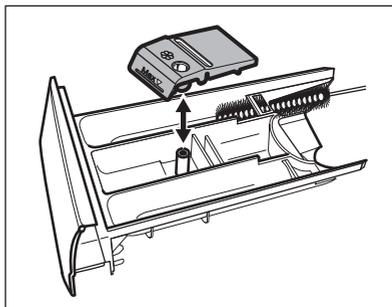
3. Sciacquare il cassetto del detersivo sotto l'acqua corrente calda per rimuovere eventuali tracce di detersivo accumulato. Dopo la pulizia, ricollocare la parte superiore in posizione.
