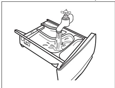
5. Verificare che tutti i residui di detersivo vengano rimossi dalla parte superiore e inferiore dell'incasso. Servirsi di una spazzola piccola per pulire l'incasso.
