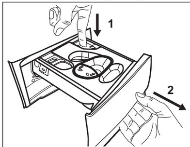
2. Rimuovere il contenitore per il detersivo liquido, se inserito.
