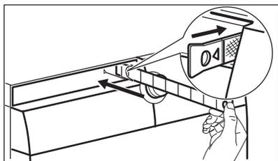
9. Re-inserire il filtro primario dell'aria e chiuderlo saldamente.
