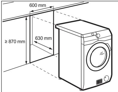
L'apparecchiatura può essere montata senza nessun supporto oppure sotto il ripiano della cucina con la corretta spaziatura (vedere figura).
