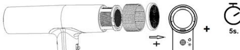
Der Motor wird aktiviert, indem die Rotationsrichtung für 15 Sekunden umgekehrt wird, um Schmutz aus Filter und internen Teilen auszustoßen. Nach Abschluss des Vorgangs den Filter (3) wieder anbringen.
