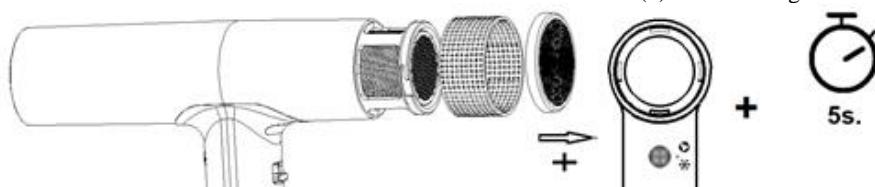
O motor é acionado invertendo o sentido de rotação por 15 segundos, expulsando a sujeira do filtro e das peças internas. Ao final da operação, monte novamente o filtro (3).
