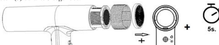
El motor se activa invirtiendo el sentido de rotación durante 15 segundos, expulsando la suciedad del filtro y de las partes internas. Al final de la operación, volver a montar el filtro (3).
