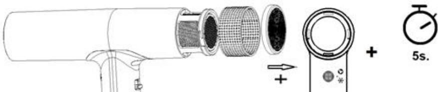
Il motore si aziona invertendo il senso di rotazione per 15 secondi, espellendo lo sporco da filtro e parti interne. Al termine dell'operazione, rimontare il filtro (3).
