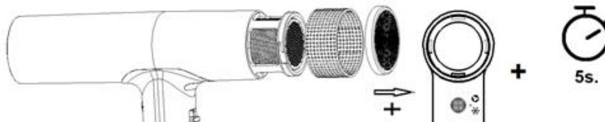
Le moteur s'active en inversant le sens de rotation pendant 15 secondes, expulsant la saleté du filtre et des pièces internes. À la fin de l'opération, remontez le filtre (3).
