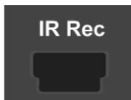
7. **IR:** per il collegamento del sensore IR del telecomando, da posizionare sul pannello frontale della TV. Il sensore IR è dotato di display con visualizzazione dell'orario in standby che può essere disattivato.
