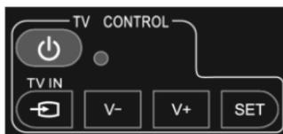
**TV CONTROL.** Impostazione telecomando TV. Nella sezione TV CONTROL premere per 3 sec. il tasto **SET**, il led rosso aumenterà di intensità. Sempre nella stessa sezione premere il tasto da impostare (es. **V+**), il led rosso lampeggerà. Posizionare il telecomando del TV di fronte a quello del decoder (in modo che i due sensori si guardino) ad una distanza di circa 3 cm.
