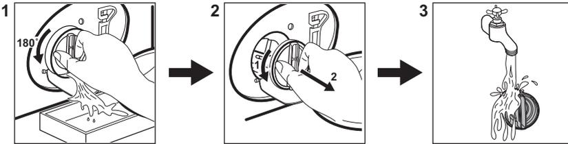
Pulire il filtro a intervalli regolati, e in particolar modo se il codice allarme **E20** viene visualizzato sul display.
