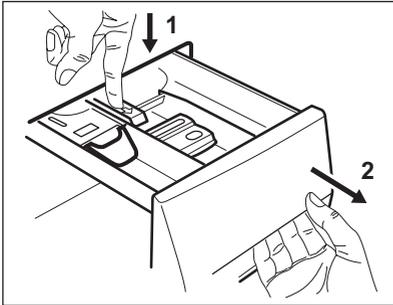
2. Togliere la parte superiore dello scomparto additivi per semplificare la procedura di pulizia. Verificare che tutti i residui di detersivo vengano rimossi dalla parte superiore e inferiore dell'alloggiamento del cassetto. Servirsi di una spazzolino per pulire l'alloggiamento.
