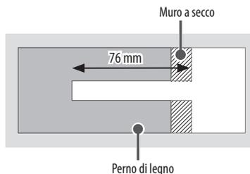
Utilizzare una punta da trapano da  $\varnothing$  4 mm per legno per praticare fori con una profondità di 76 mm. (Pulire il foro ottenuto.)
