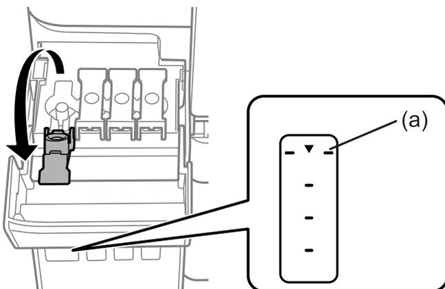
8. Allineare la parte superiore della bottiglia di inchiostro con la porta per il riempimento, quindi inserirla direttamente nella porta per versare l'inchiostro. Il flusso si interrompe automaticamente una volta raggiunta la linea superiore.
