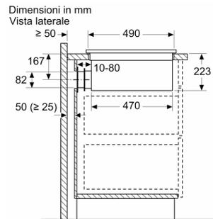
Se si effettua l'installazione direttamente contro pareti esterne non coibentate ( $\mu \geq 0,5 \text{ W/m}^2 \cdot \text{C}$ ), consigliamo di usare configurazioni con ricircolo parzialmente o completamente canalizzato.
