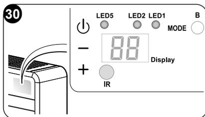
⏻ Ativação/desativação (Stand-by) do ar condicionado e seleção da velocidade de ventilação.
