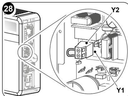
Na configuração de contacto Energy boost ou System enable o visor exibe **PI**.
