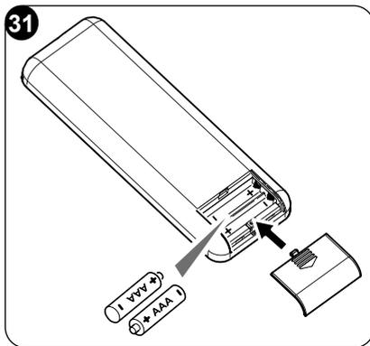
Il telecomando utilizza due batterie alcaline a secco da 1,5V (tipo AAA.LR03) (fig. 31). Dopo la sostituzione delle batterie, regolare l'orologio del telecomando.
