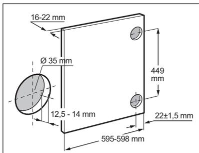
Impostare la posizione del foro inferiore rispettando le dimensioni e le distanze indicate nel disegno (449 mm).
