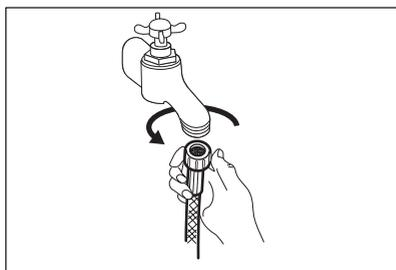
3. Collegare il tubo flessibile alla parte posteriore dell'apparecchiatura. Non ruotare il tubo flessibile di ingresso acqua verso il basso; ruotarlo verso sinistra o destra a seconda della posizione del proprio rubinetto.
