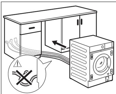
Questa apparecchiatura è stata progettata per il montaggio a incasso in un mobile. Vedere le dimensioni di incasso minimo negli schemi.
