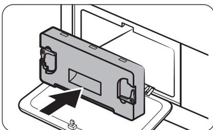
5. Rimontare il coperchio interno nella sua posizione originale e chiudere le leve di fissaggio.
