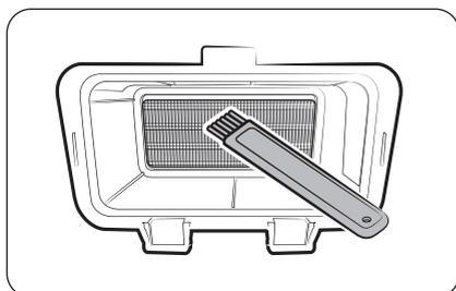
3. Pulire lo sporco accumulato nello scambiatore di calore usando la spazzola in dotazione.
