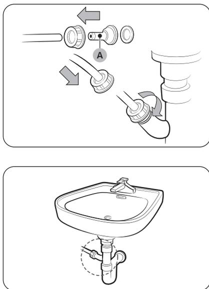
1. Montare il **connettore del tubo (A)** e fissarlo all'estremità del tubo accessorio come mostrato in figura.
