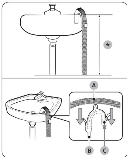
1. Posizionare l'estremità del tubo accessorio con un angolo inferiore ai **90 cm (\*)** dal fondo della asciugatrice.
