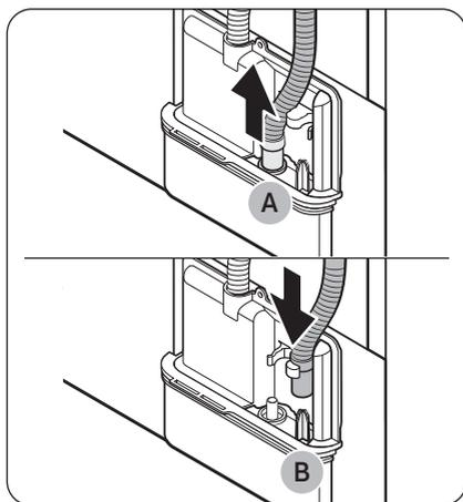
2. Inserire una estremità del tubo accessorio (tubo di scarico lungo) nel **foro (A)**.
