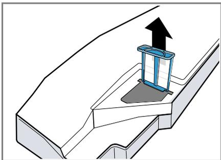
3. Lavare il filtro con l'acqua corrente calda oppure in lavastoviglie.
