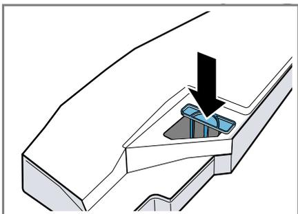
5. Inserire il contenitore dell'acqua di condensa.
