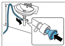
Fissare il punto di collegamento con una fascetta stringitubo (12-22 mm). Fissare il tubo flessibile di scarico dell'acqua con una guida del tubo flessibile a un'altezza minima di 80 cm e massima di 100 cm.
