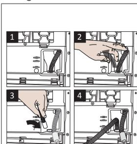
**1-2** Tirare il tubo sul lato posteriore dell'asciugatrice a mano per scollegarlo dal punto in cui era collegato. Non usare strumenti affilati in fase di pulizia dell'interno dell'asciugatrice.
