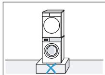
Installare questo apparecchio in una colonna lavatrice-asciugatrice soltanto con il set di collegamento originale del produttore dell'asciugatrice.
